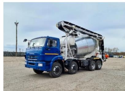
**Конвейер-манипулятор** предназначен для подачи бетонной смеси (щебня, песка или любых других сыпучих материалов) из автобетоносмесителя непосредственно в место укладки или перегрузки в другие бетонотранспортные устройства: бетононасосы, конвейеры, тару и т.п. Применение конвейера значительно расширяет возможности автобетоносмесителя при бетонировании объектов.
